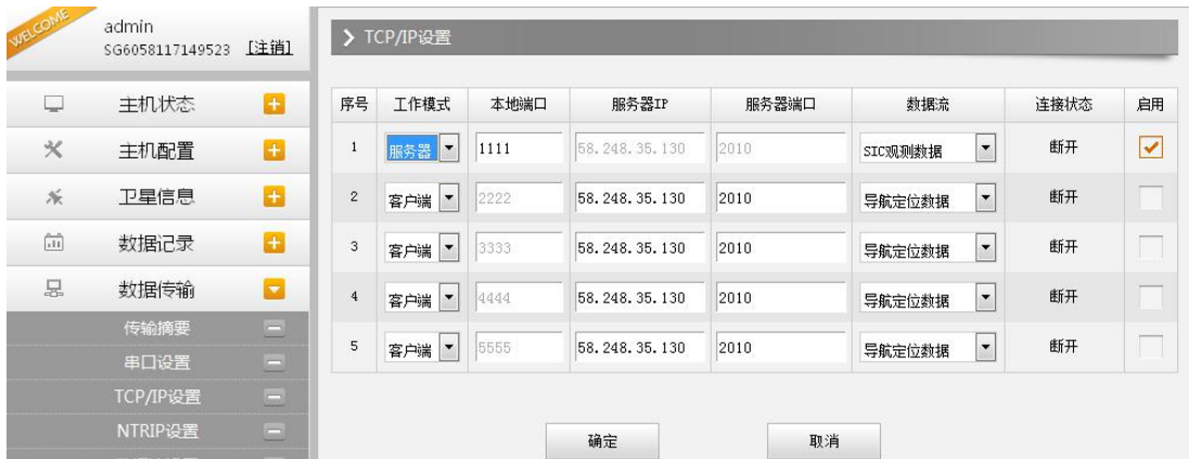
图 2.3-20 Web UI 数据传输-TCP/IP 设置: 服务器
