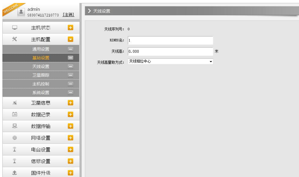
图 2.3-7 Web UI 主机配置-基站设置
