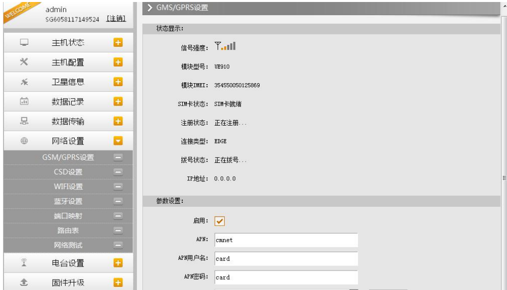
图 2.3-23 Web UI 网络设置-GSM/GRPS 设置
