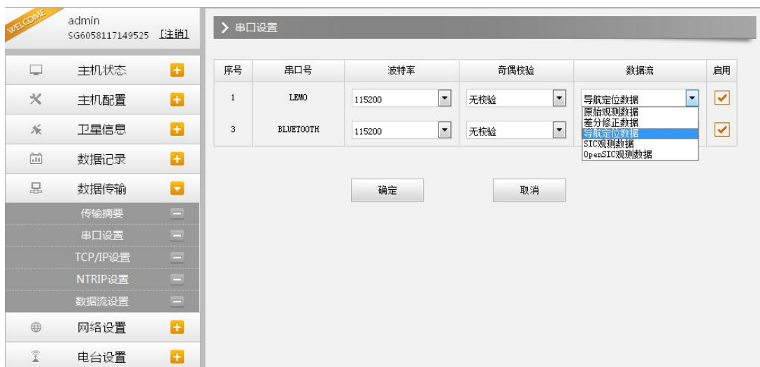
图 2.3-18 Web UI 数据传输-串口设置
