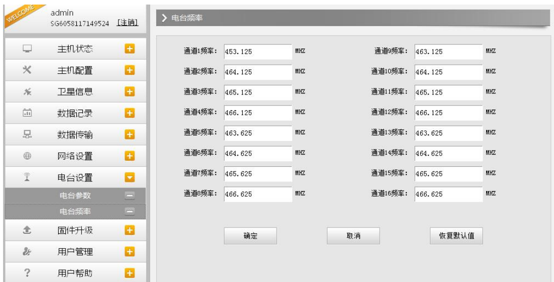
图 2.4-32 Web UI 电台设置-电台频率
