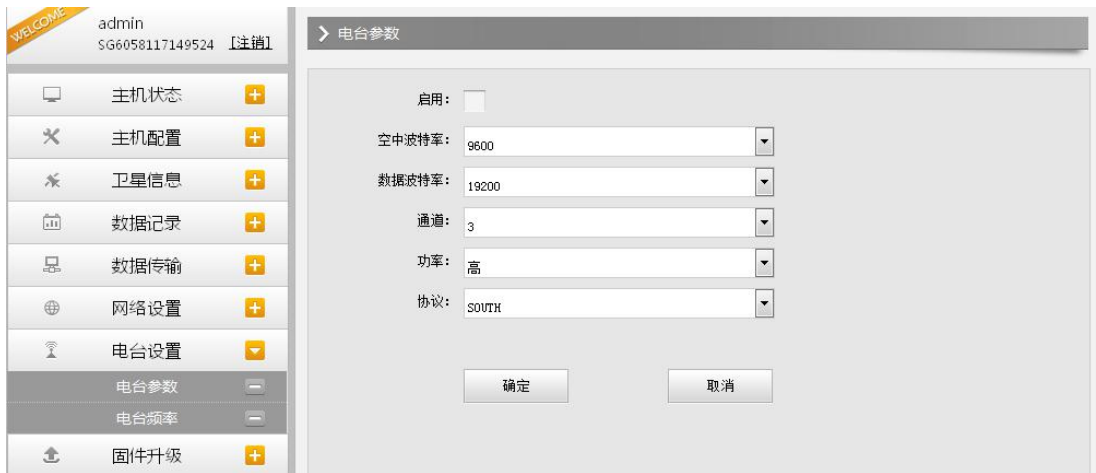
图 2.3-31 Web UI 电台设置-电台参数
