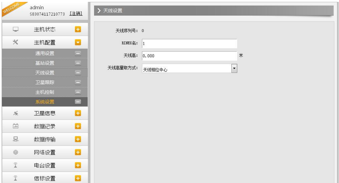
图 2.3-8 Web UI 主机配置-天线设置
