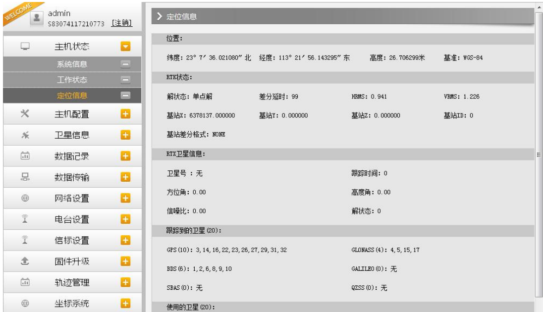
图 2.3-5 Web UI 主机状态-定位信息
