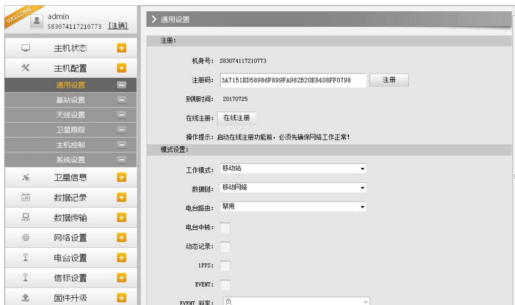
图 2.3-6 Web UI 主机配置-通用设置
